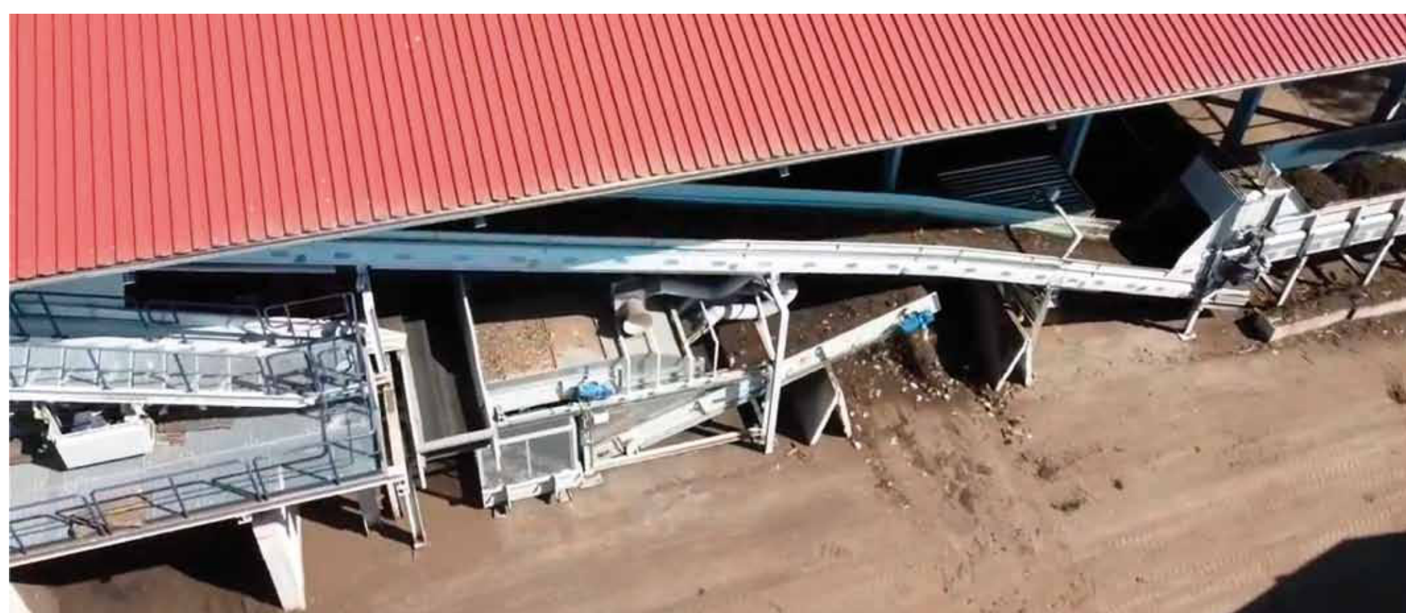
Durch die Hallen wird das Material auf den Förderbändern der Aufbereitungsanlage transportiert.
