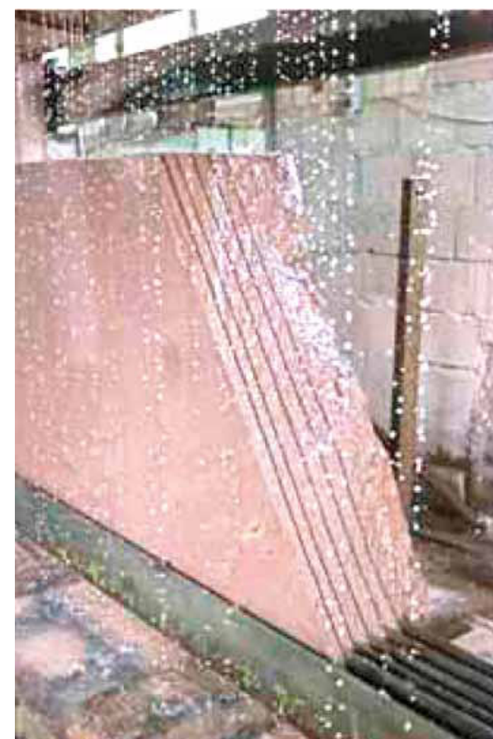
An der ersten Steinsäge in den 1950er Jahren arbeitet Rudi Dittmeier. Im 21. Jh. ermöglicht die diamantbesetzte Gattersäge die Herstellung von dünnen Sandsteinplatten.
