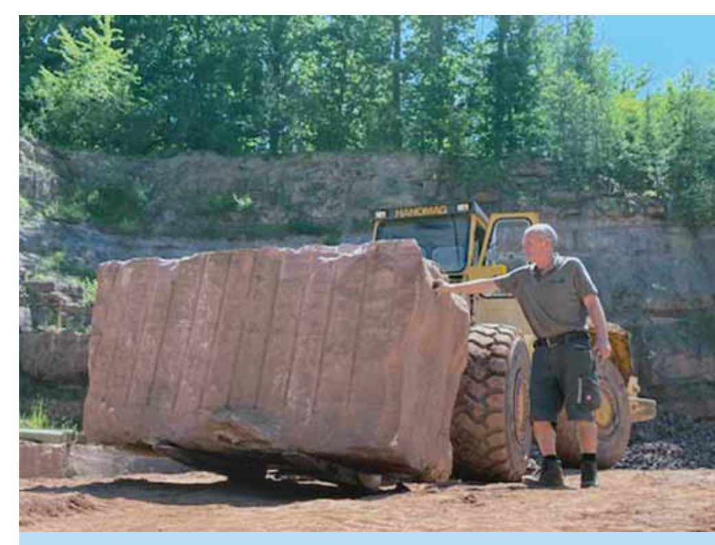
Sprengung und Abtransport eines Buntsandsteinquaders
