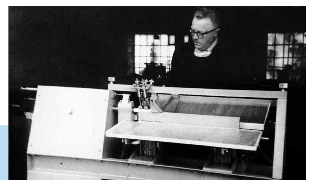
Alfred Herrhammer im Jahr 1950 mit der ersten selbst gebauten Kerzen-Fräsmaschine „FB-I“.
