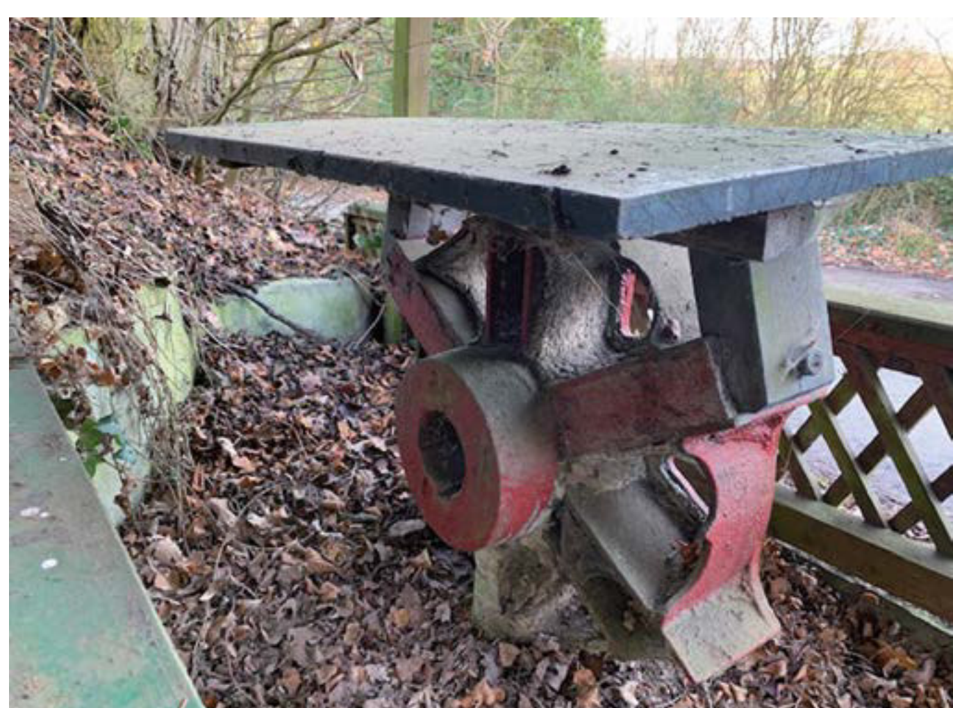
Erinnerung an alte Zeiten: Das Wasserrad der früher in die Mühle zur Energieerzeugung eingebauten Turbine.
