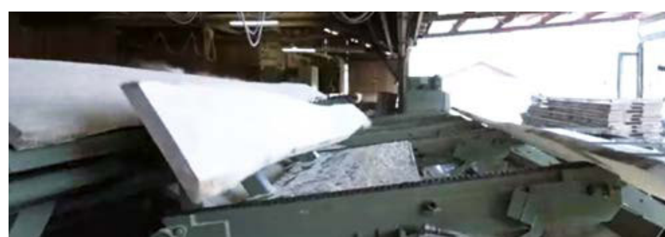
Auch die Staplung des frischen Schnittholzes ist automatisiert.
