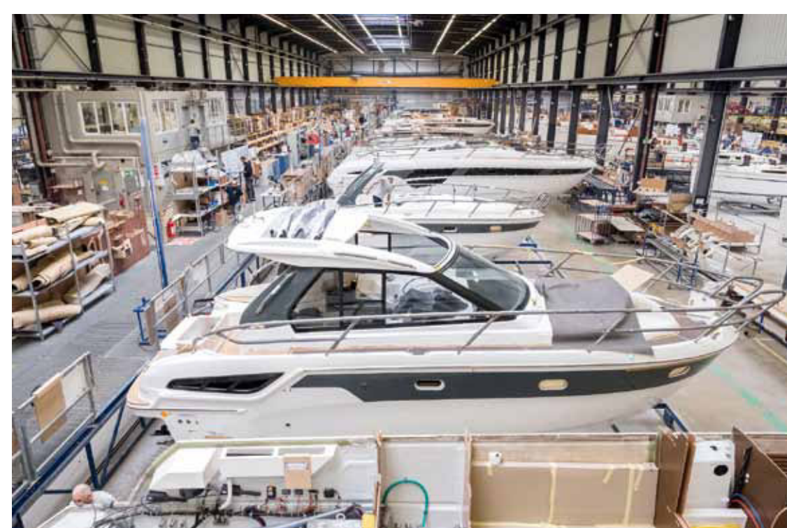
Produktion von Motorbooten am Band
