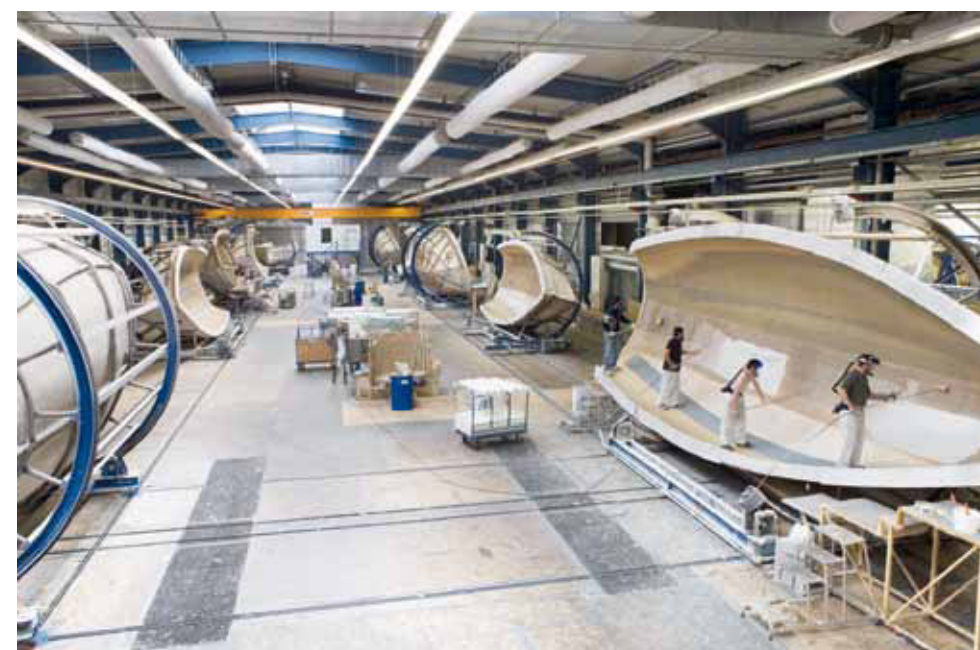
Laminierung der Rümpfe und der Einsatz von fertigen Möbelmodulen ins Boot
