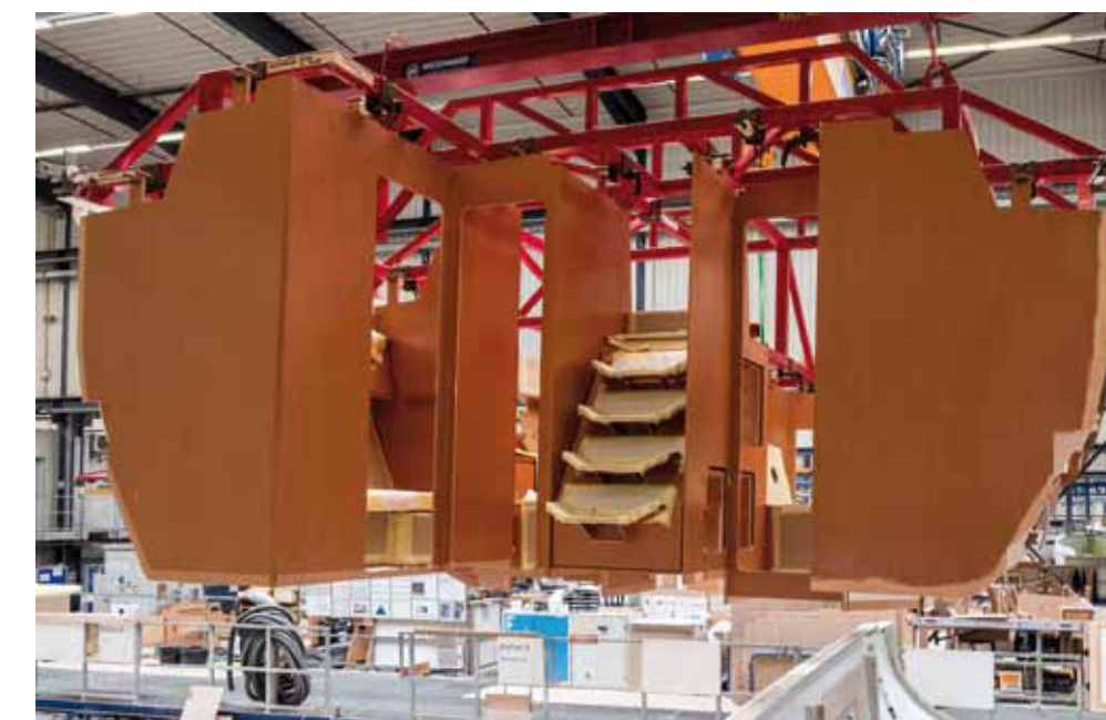
Laminierung der Rümpfe und der Einsatz von fertigen Möbelmodulen ins Boot
