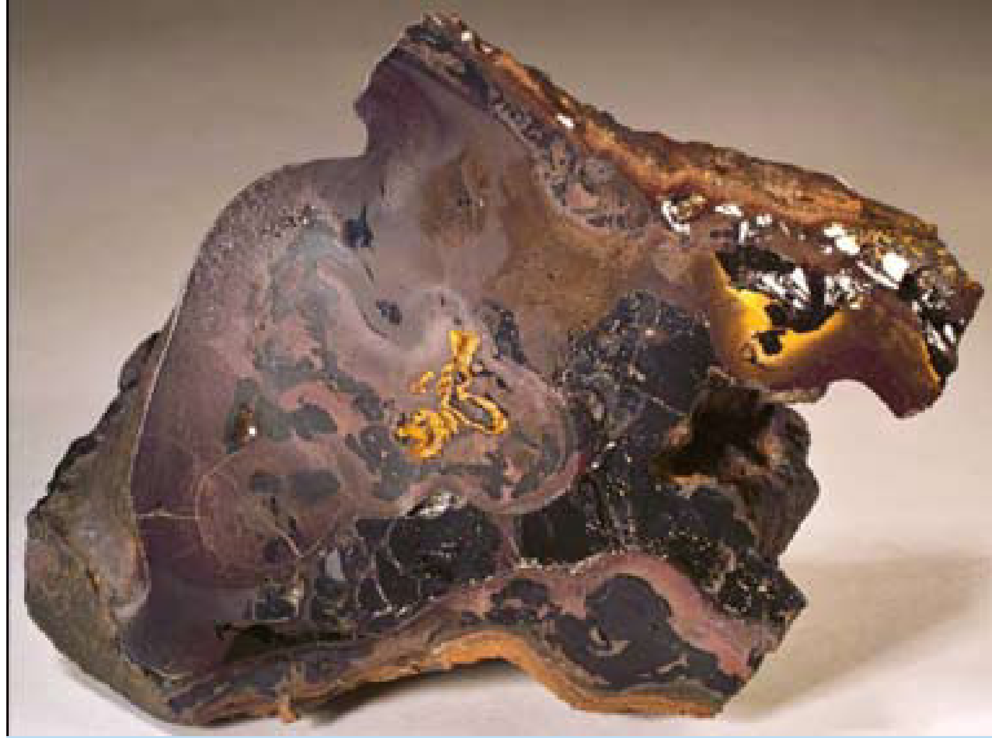
Typisches Manganerz (schwarzer Romanèchit) mit Eisenerz (brauner Goethit) mit weißem Baryt wie es aus der Grube Heinrich gefördert wurde; Bildbreite ca. 8 cm.
