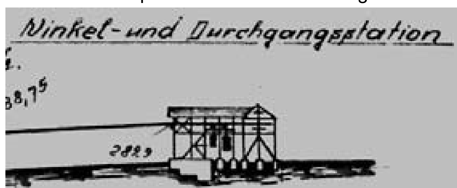
Die Winkelstation im Planungsstadium. Gut zu erkennen sind die beiden hängenden Gegengewichte, deren Reste vor Ort verblieben sind.
