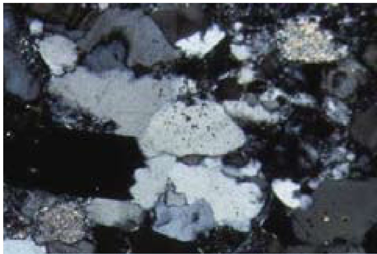
Dünnschliffbild eines weißen Sandsteines: Alle punktiert aussehenden Körner bzw. Zwischfüllungen sind Tonminerale, der Rest besteht aus Quarz (gekreuzte Polarisatoren, Bildbreite 3 mm).
