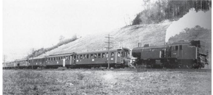
Um 1930 schiebt eine Mallet-Lokomotive vermutlich den Fernzug Holland-Wien über die Spessartrampe.
