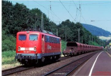
Quasi der „Stargüterzug“ auf der Spessartrampe ist der „Jumbo“, der Erzzug Moers-Linz Stahlwerke. Grenzlast für die beiden 15er E-Loks vorne und die schiebende 150 sind 3.180 Tonnen, wiegt er mehr, wird mit beiden vorhandenen Loks geschoben.
