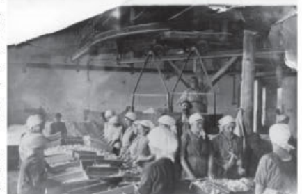
In der Spatmühle sortierten im Saal der Spatwäsche Frauen taubes Gestein aus. Der Schwerspat wurde in zwei Gängen gemahlen und darauf mit (in Partenstein hergestellten) Fässern, die bis zu 50 Zentnern fassten, auf Fuhrwerken zum Bahnhof gebracht.
