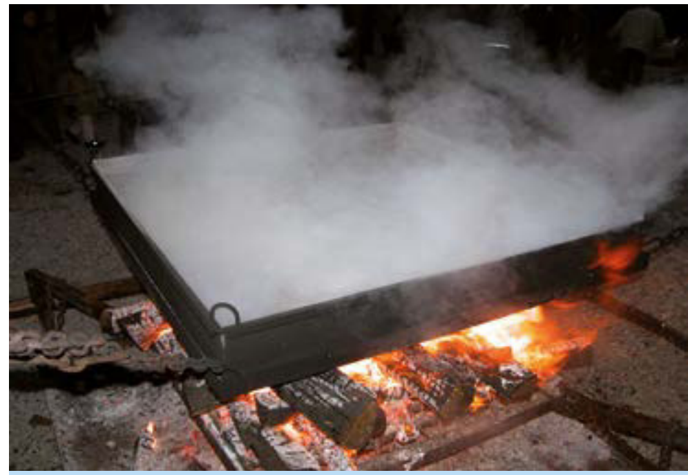
In Salzpflanzen wie diesen wurde früher in Orb das salzhaltige Quellwasser verdampft und auf diese Weise Salz gewonnen.
