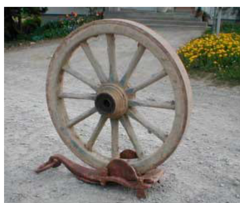
Bei der Talfahrt wurde der Bremschuh unter das Rad gelegt.
