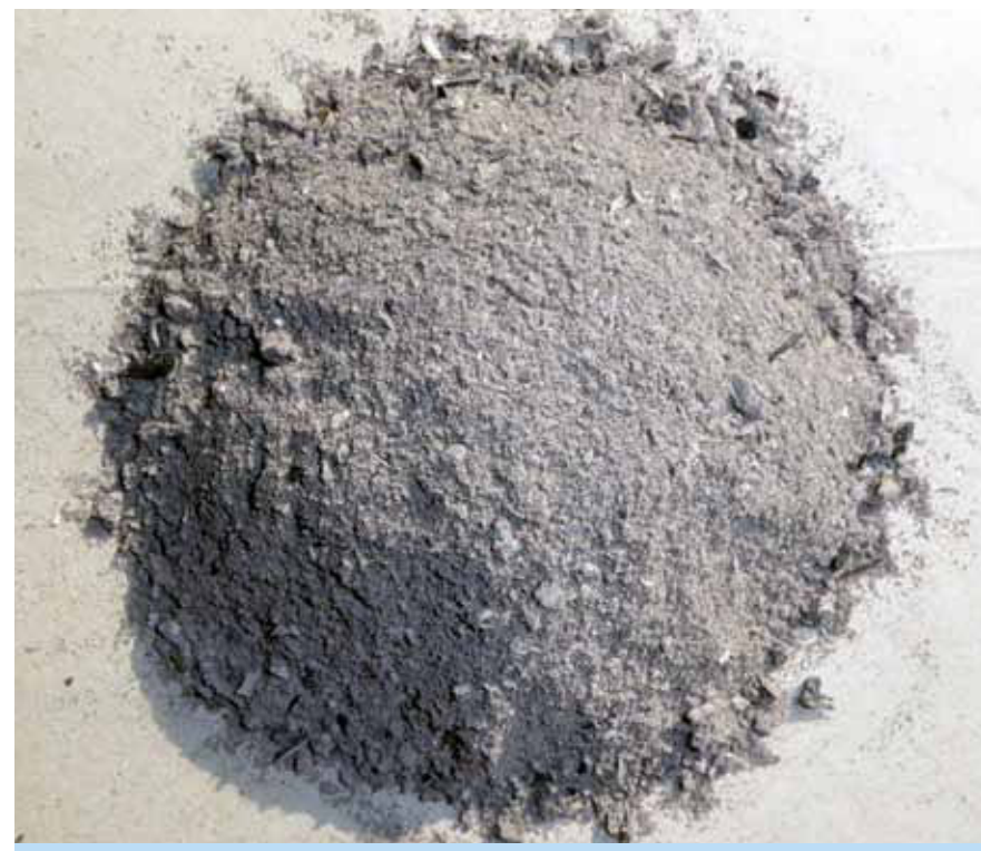
Der Rohstoff zur Herstellung von Glas ist das Gemenge, das aus einem Teil Sand (Glasbildner) und zwei Teilen Holzasche zur Senkung des Schmelzpunktes besteht. Pottasche konnte damals noch nicht hergestellt werden.
