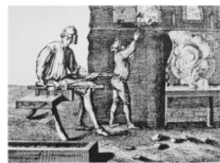
Die Abbildung aus der Enzyklopädie von Diderot und D'Alembert aus der Mitte des 18. Jahrhunderts zeigt die Fertigstellung eines Kelchglases durch einen Glasmacher. Ähnlich haben wir uns diesen Vorgang in der Emmerichsthaler Glashütte vorzustellen.
