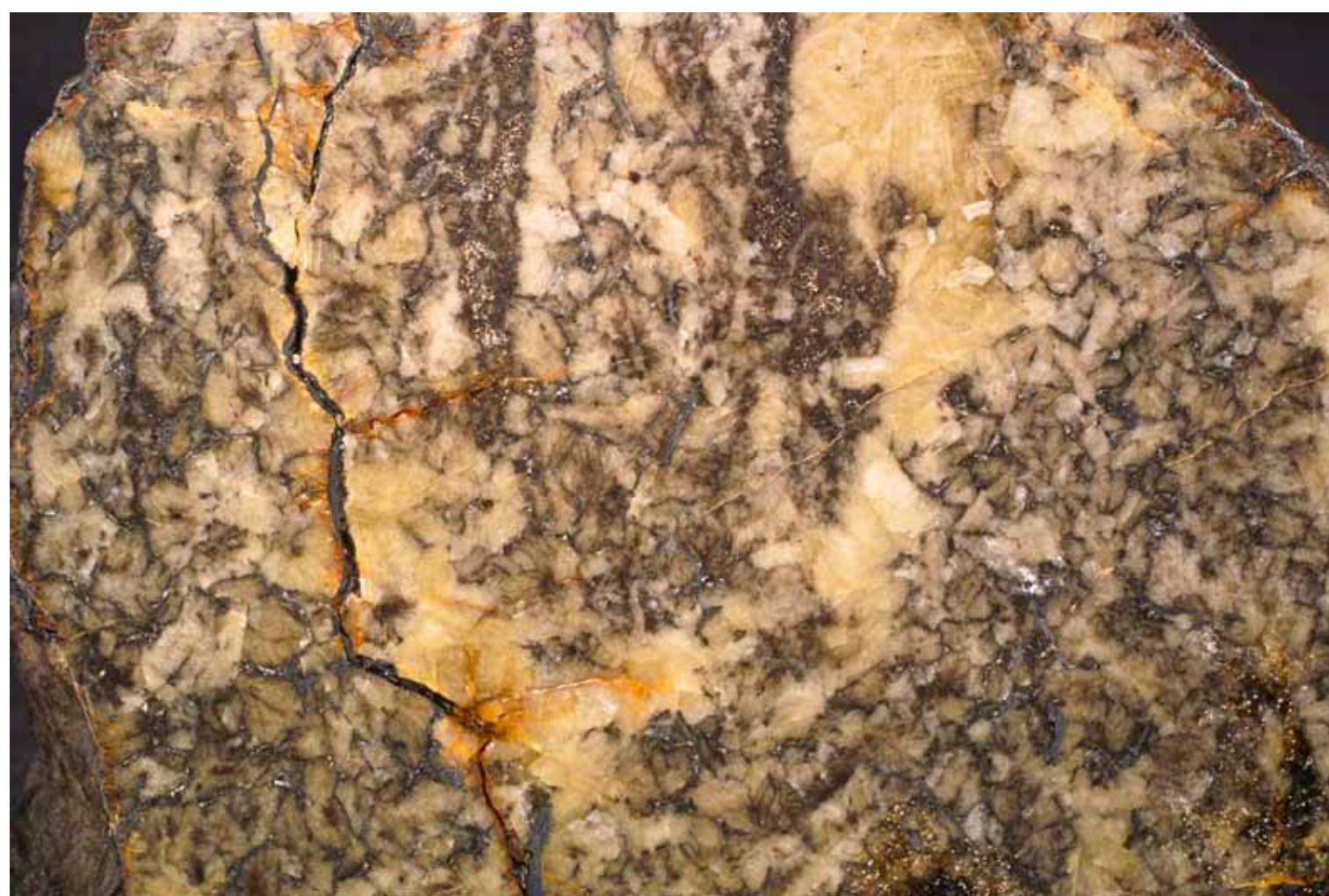
Das gesuchte Eisenerz aus Bieber: Hellbrauner, grobkristalliner Siderit ohne Baryt und andere Mineralien als Gestein aus dem Lochborn bei Bieber, Bildbreite 6 cm, angeschliffen und poliert. Das Gegenstück befindet sich im Museum in Biebergemünd.
