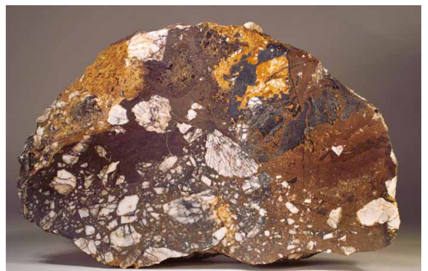
Als Erz nicht verwertbar und deshalb typischer Haldenfund der Tagebaue im Lochborn: Brauner Goethit (Eisenhydroxid) mit schwarzem Romanechit (Barium-Manganoxid) und weißem, brekziiertem Baryt (Schwerspat), Bildbreite 17 cm, angeschliffen und poliert.
