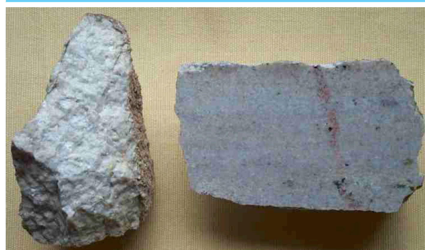
Geschliffene und polierte Fläche eines Marmors aus dem „Weißen Steinbruch“. Der dunkle Streifen ist eine Störung. Die Außenflächen beider Stücke sind wegen des Anlösens der Karbonate durch das Regenwasser sehr rau (Haldenfunde).
