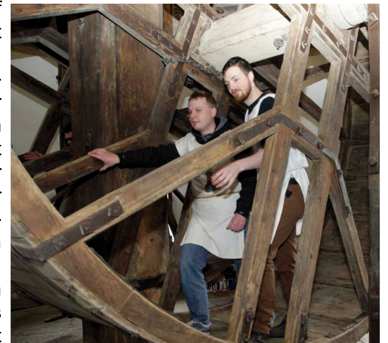
Der Alte Kranen am Mainufer in Marktbreit stammt aus dem 18. Jahrhundert - im Inneren ist das Laufrad des Kranengetriebes noch drehbar.
