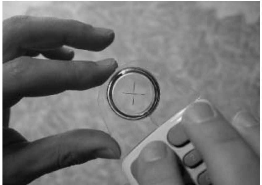
Digitalisierlupe mit Fadenkreuz - Werkzeug um Informationen beispielsweise von Karten in den Computer zu übertragen
