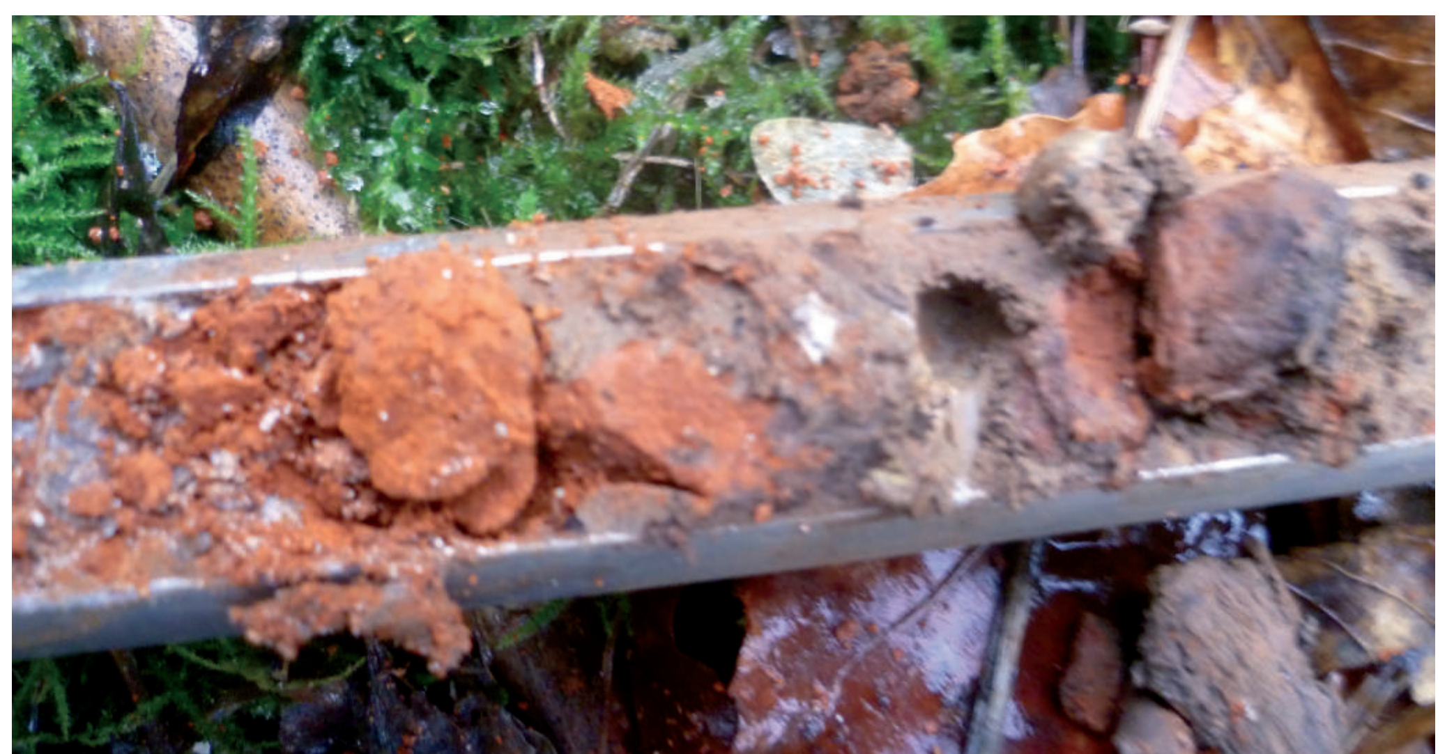
Bodenproben, die mit dem Pürckhauer-Erdbohrstock entnommen wurden, weisen durch die Ziegelanteile darauf hin, dass sich am Kaltenbrunn eine Siedlung befunden haben kann.
